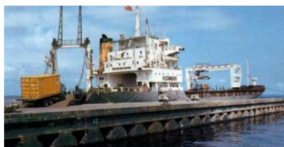
Figura 3 – Ilustração do carregamento de contêineres por acesso em rampa.
