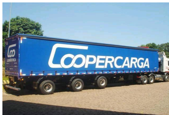
Figura 2 – Carreta Sider com eixos distanciados Fonte: Rodofort – Implementos rodoviários,2010
