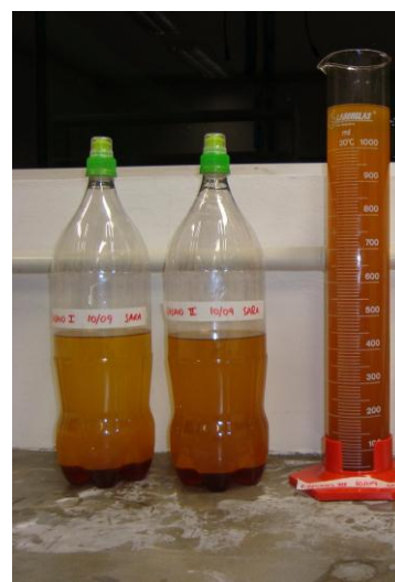
Figura 2 - Decantação com duas fases visíveis; no fundo a glicerina
