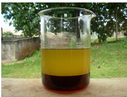
Figura 12 – Biodiesel de óleo de fritura com duas fases separadas por decantação: éster metílico e glicerol.
