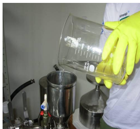
Figura 3 – Carregamento de metanol e hidróxido de sódio.
