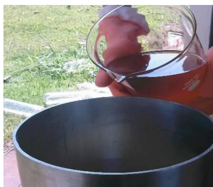
Figura 10 – Carga de óleo de fritura e de água para processo de lavagem.
