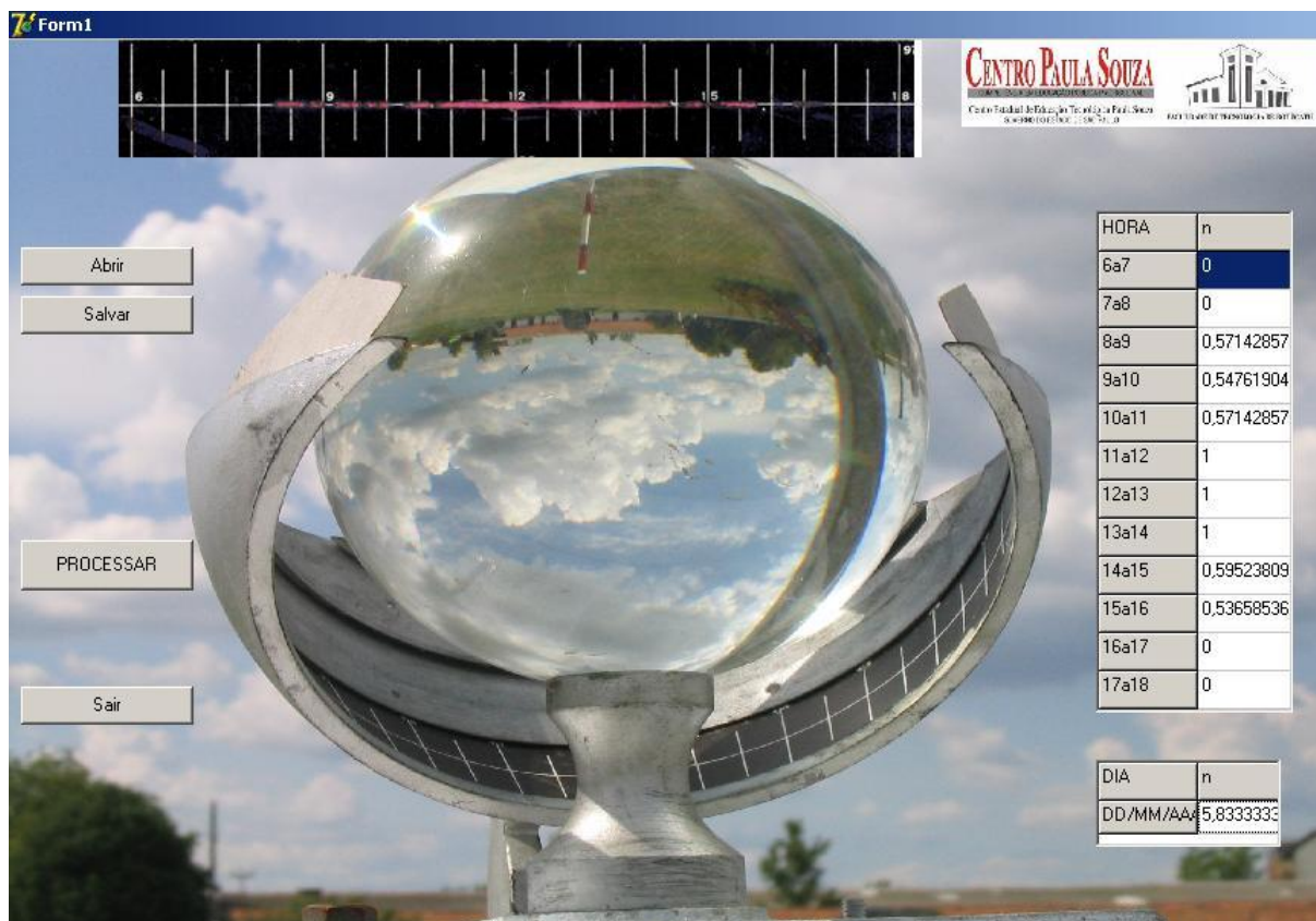
Figura 14. Módulo Contagem. Identificação de intervalos horários e contabilização de pixels (minutos).
