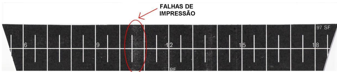
Figura 10. Amostra de heliograma com presença de ruído e/ou granularidade.
