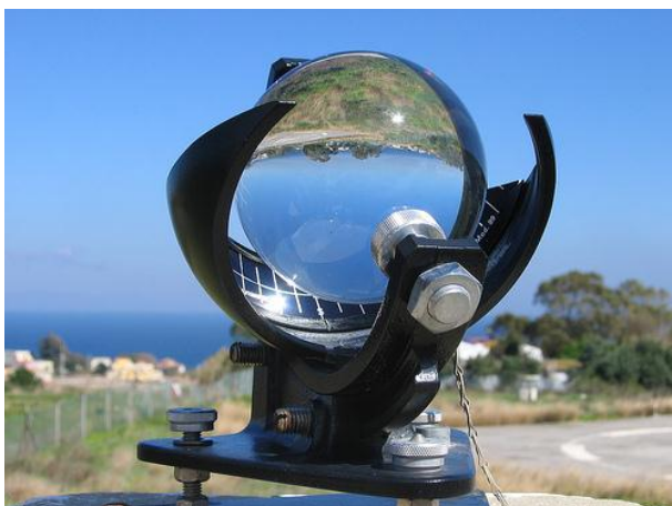
Figura 4. Heliógrafo para medir horas de brilho solar.
