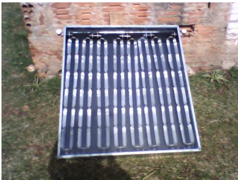
Figura 13 - Aquecedor solar de baixo custo. (Silva (2008)).
