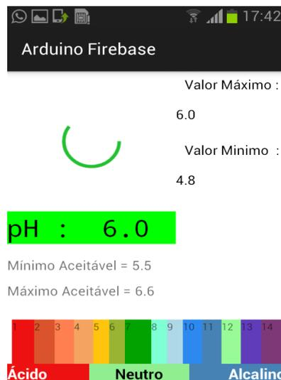
O sensor utilizado apresentou uma leitura eficiente do pH de uma solução, levando um tempo entre 30 segundos e 1 minuto para estabilizar esta leitura, tempo observado com testes de soluções com pH 4,0 e 6,8.
