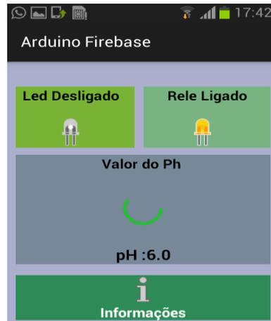
A Tela de leitura do sensor (FIGURA 10) também é composta por uma barra de progresso, que é alterada de acordo com a leitura valor do sensor e demonstra os valores máximo e mínimo lidos pelo sensor, além de informações de valores mínimo e máximo aceitáveis para a automação em específico, onde o valor do sensor deverá estar entre o mínimo e máximo aceitável. Ainda conta com uma tabela de coloração com a faixa de valores de pH, que o sensor suporta.
