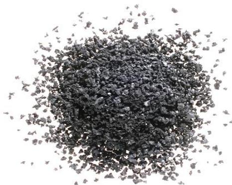
Figura 1. Borracha pulverizada ou granulada.
