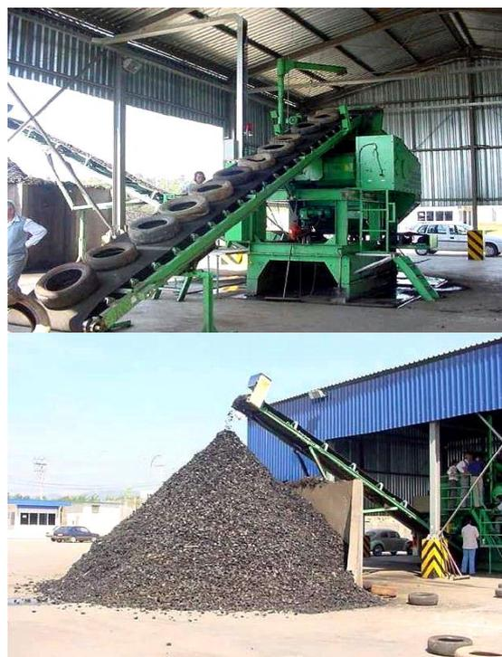
Figura 6. Unidade de trituração de pneumáticos inservíveis.
