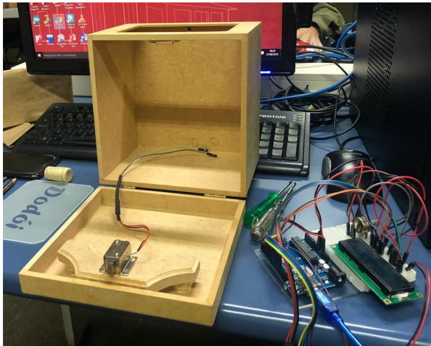
Figura 12 - Montagem cofre e eletrônica
