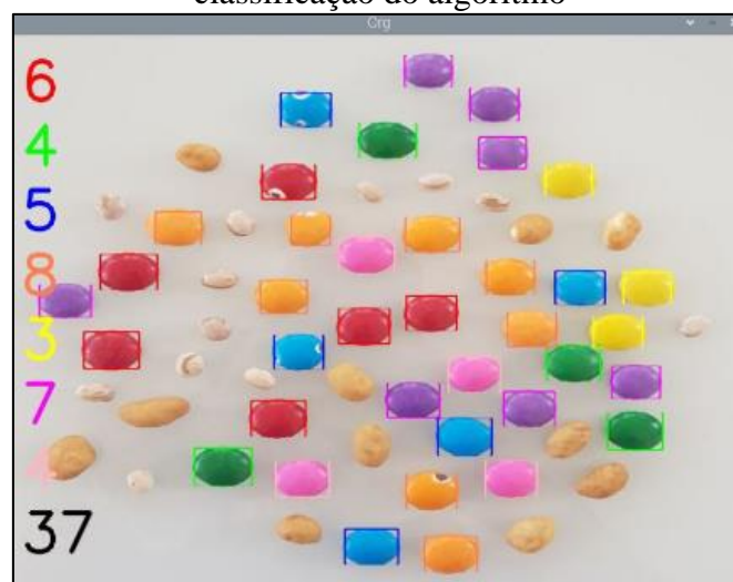
Figura 7: Classificação de M&M's com outros objetos aleatórios para dificultar a classificação do algoritmo
