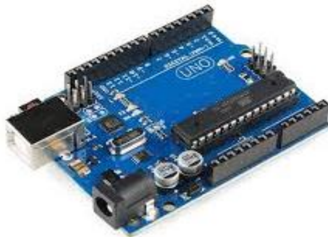
Figura 1- Arduino Uno R3
