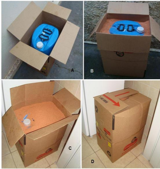
Figura 7 A; B; C e D – Teste com isolamento térmico com papelão e serragem.
