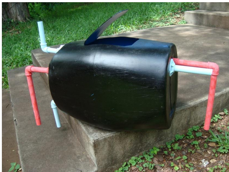
Figura 2 – Reservatório térmico com material reciclável finalizado.
