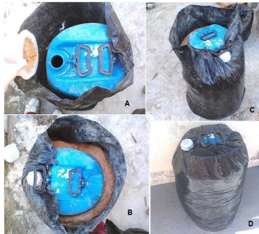
Figura 5 A; B; C e D – Teste com isolamento térmico com plástico e serragem.
