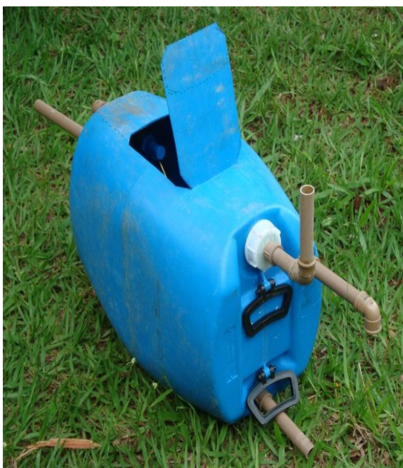
Figura 1 – Reservatório térmico com material reciclável.
