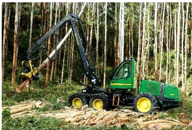
Figura 1 – Máquina utilizada na colheita mecanizada – Harvester .
