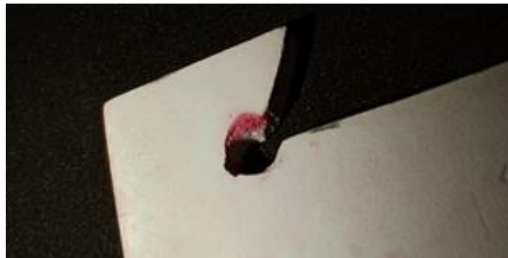
Figura 11. Trinca no rasgo da peça
