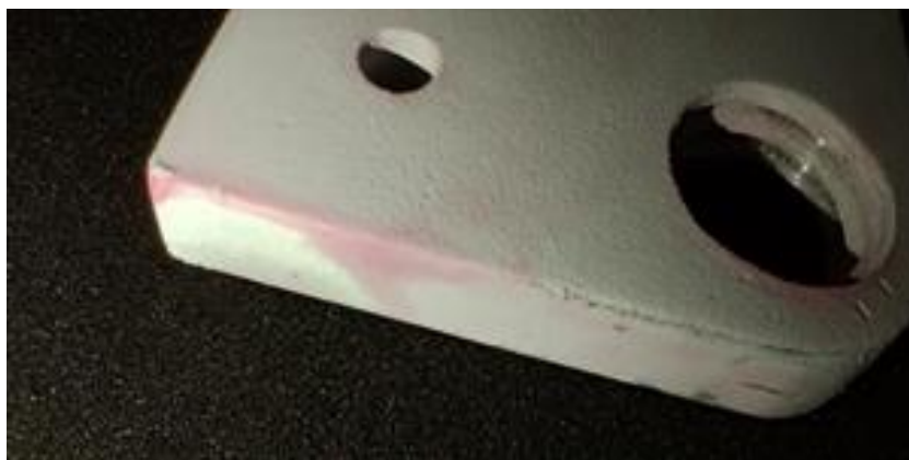
Figura 20. Primeira descontinuidade de acabamento no quarto corpo de prova
