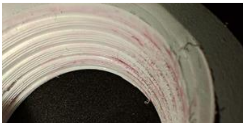
Figura 18. Trincas na rosca do terceiro corpo de prova
