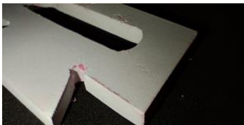
Figura 15. Trinca no rasgo do segundo corpo de prova
