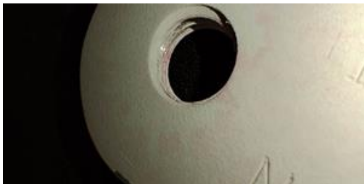
Figura 12. Descontinuidade de acabamento do primeiro corpo de prova
