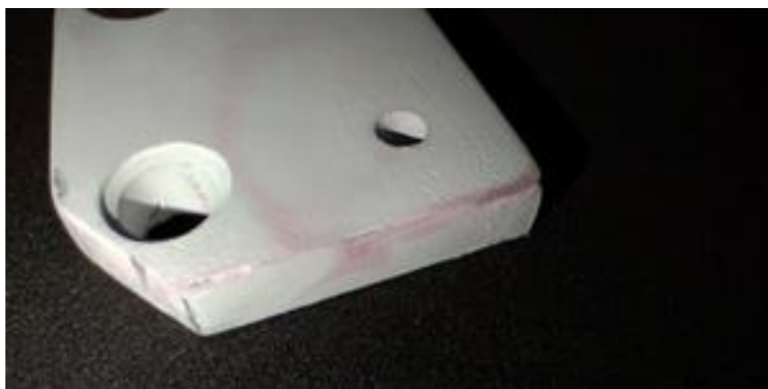
Figura 21. Segunda descontinuidade de acabamento no quarto corpo de prova
