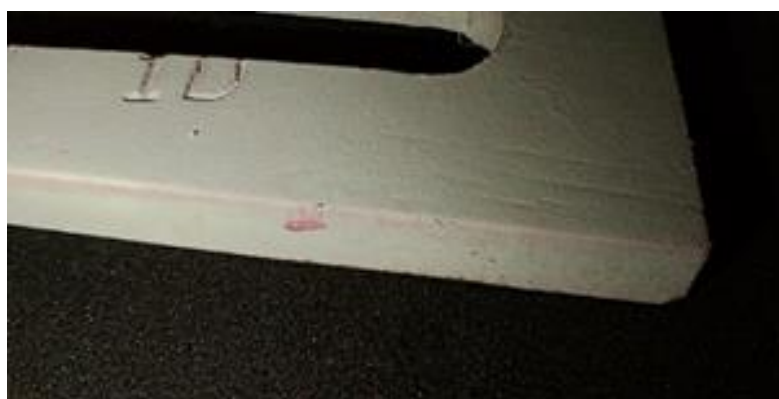
Figura 14. Primeira trinca do segundo corpo de prova
