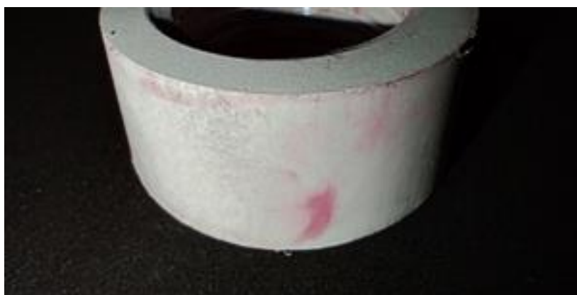
Figura 17. Acabamento defeituoso no terceiro corpo de prova
