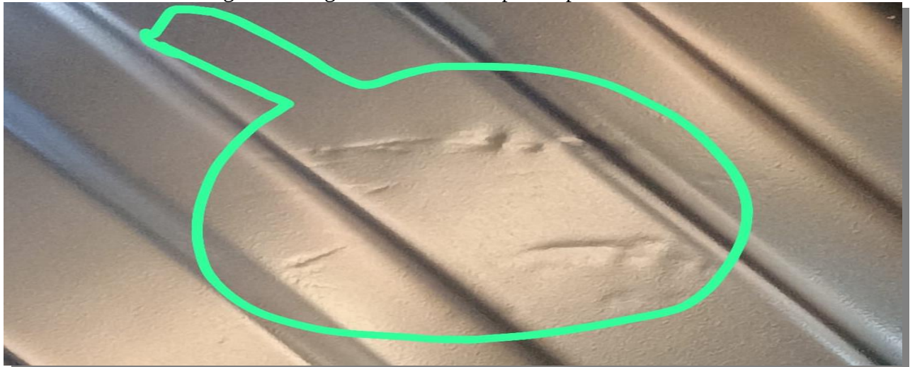
Figura 3. Irregularidades das chapas do para-lama
